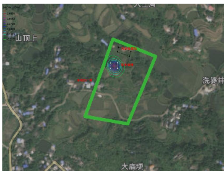
图 5-50 氨水储槽泄露 100d 后氨氮污染情况
