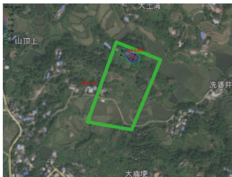
图 5-47 污水站泄露 100d 后氨氮污染情况
